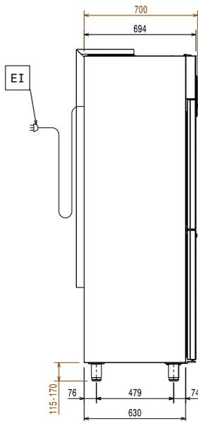
EI = Conexión eléctrica (energía)
